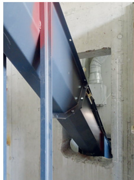
Schneckenförderer für Holzsznitzel
