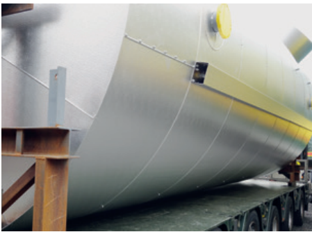
Anlieferung des Pufferspeichers per Sondertransport
